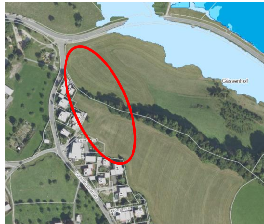
Abb. 7: Überflutungsflächen im Umfeld des Bebauungsplangebiets (hellblau: HQ-Extrem, dunkelblau: HQ-100) (Quelle: LUBW Online-Kartendienst 2022).
